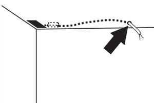
Com o driver no local, passe os cabos de saída (LED+ e LED-) até o local onde será fixada a luminária
